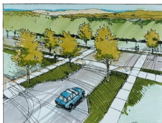
Rys.4. a) zwężenie wlotu na skrzyżowanie z wykorzystaniem zieleni, b) brukowane opaski optycznie zwężające przekrój
